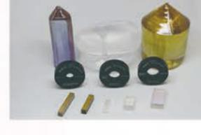
晶体 **双折射、激光晶体**
